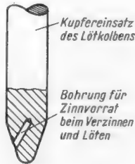
LötKolbenspitze mit Bohrung in der Kolbenschneide
