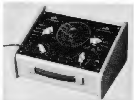
Bild 2. Außenansicht des RC-Generators Oszillophon OSP 3; Frontplatte für Bedienung im Stehen um 15° geneigt
